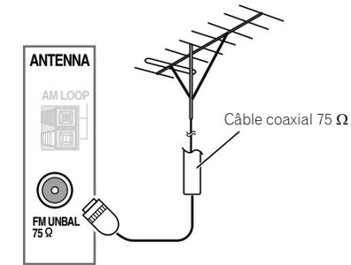
Pour améliorer la qualité de la réception AM, raccordez un fil recouvert de vinyle de 5 m à 6 m de long aux bornes **AM LOOP** sans débrancher l'antenne cadre AM fournie. Pour obtenir le meilleur son possible, suspendez l'antenne à l'horizontale à l'extérieur.
