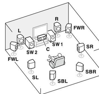
Selon ce plan, les enceintes avant gauche et droite en position haute, comme indiqué en [A], sont remplacées par des enceintes avant gauche et droite en position large (**FWL/FWR**).
