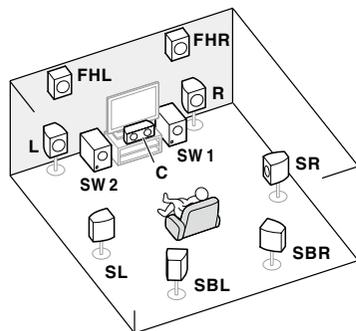
Dans un système surround impliquant 7,2 canaux, les enceintes avant gauche et droite (**L/R**), l'enceinte centrale (**C**), les enceintes avant gauche et droite en position haute (**FHL/FHR**), les enceintes surround gauche et droite (**SL/SR**), les enceintes surround arrière gauche et droite (**SBL/SBR**) et les caissons de grave (**SW 1/SW 2**) doivent être raccordés.
