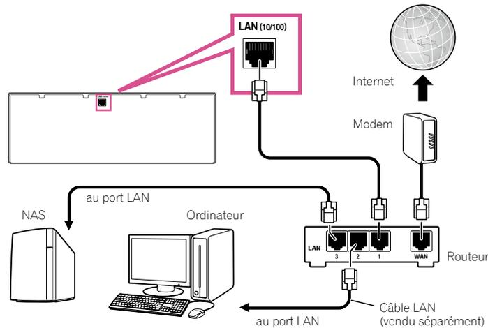
Raccordez la borne LAN de ce récepteur à la borne LAN de votre routeur (avec ou sans fonction de serveur DHCP) par un câble LAN direct (CAT 5 ou supérieur). Mettez la fonction de serveur DHCP de votre routeur en service. Si votre routeur ne présente pas cette fonction, il faudra paramétrer le réseau manuellement. Pour plus d'informations, consultez la section [Menu de configuration du réseau](#) à la [page 84](#).
