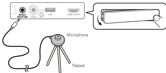
Positionnez le microphone sur un trépied (si vous en avez un) pour qu'il se trouve à hauteur d'oreilles en position d'écoute normale. Sinon, utilisez autre chose pour poser le microphone.
