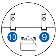
**MAIN ROOM :** Il s'agit de la combinaison d'un système 5.1 et d'enceintes en hauteur avant. Une enceinte en hauteur avant est un type d'enceinte en hauteur. Vous pouvez sélectionner uniquement un jeu d'enceintes en hauteur parmi les trois types suivants pour le raccordement.
