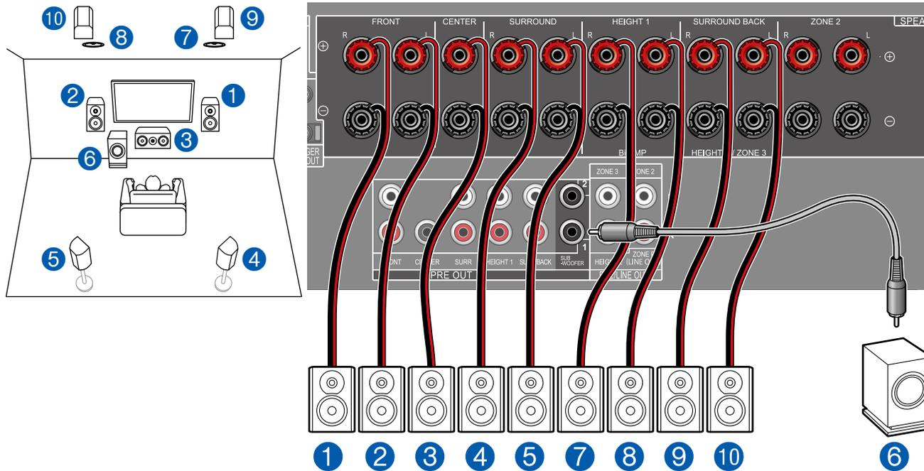
Il s'agit d'un exemple de combinaison d'enceintes pour plafond centrales à l'avant et d'enceintes en hauteur arrière à l'arrière sur le système 5.1. Il est possible de sélectionner les enceintes en hauteur à l'avant parmi les 4 types suivants. Les enceintes en hauteur pouvant être combinées à l'arrière diffèrent selon les enceintes en hauteur utilisées à l'avant.
