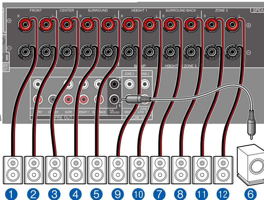
**MAIN ROOM :** Il s'agit de la combinaison d'un système 7.1 et d'enceintes en hauteur avant. Une enceinte en hauteur avant est un type d'enceinte en hauteur. Vous pouvez sélectionner uniquement un jeu d'enceintes en hauteur parmi les trois types suivants pour le raccordement.
