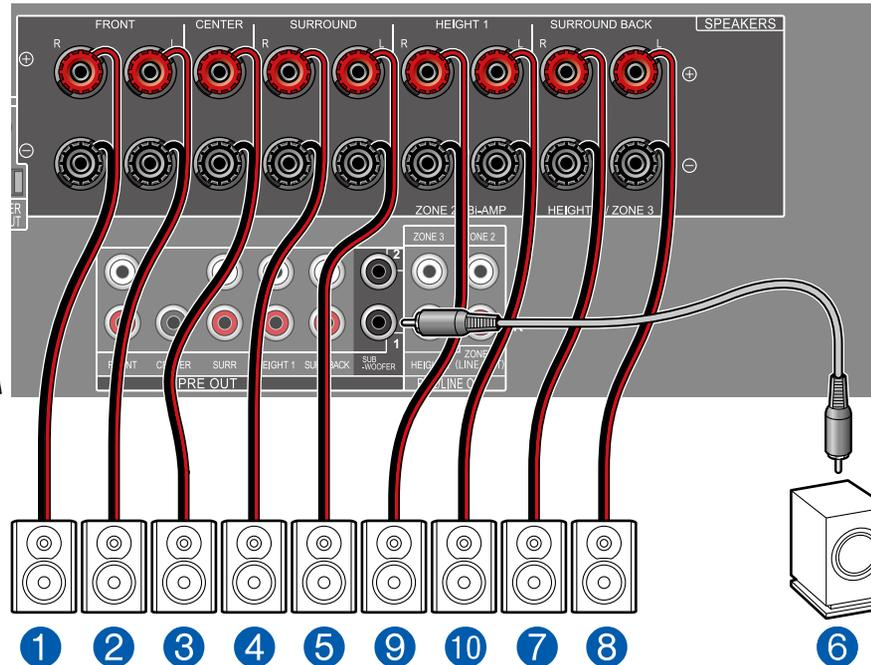
**MAIN ROOM :** Il s'agit d'un système 7.1 constitué du système 5.1 de base auquel ont été rajoutées des enceintes surround arrière. Pour plus de détails sur la disposition d'enceinte, consultez "Installation d'enceintes" (→p21).
