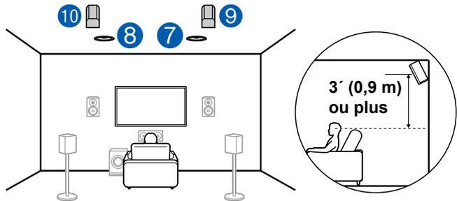
La distance entre les enceintes en hauteur arrière doit correspondre à celle des enceintes avant, et elles doivent être installées avec une élévation d'au moins 3'/0,9 m de plus que les enceintes avant, et avec une inclinaison de sorte qu'elles pointent vers la personne qui écoute.
