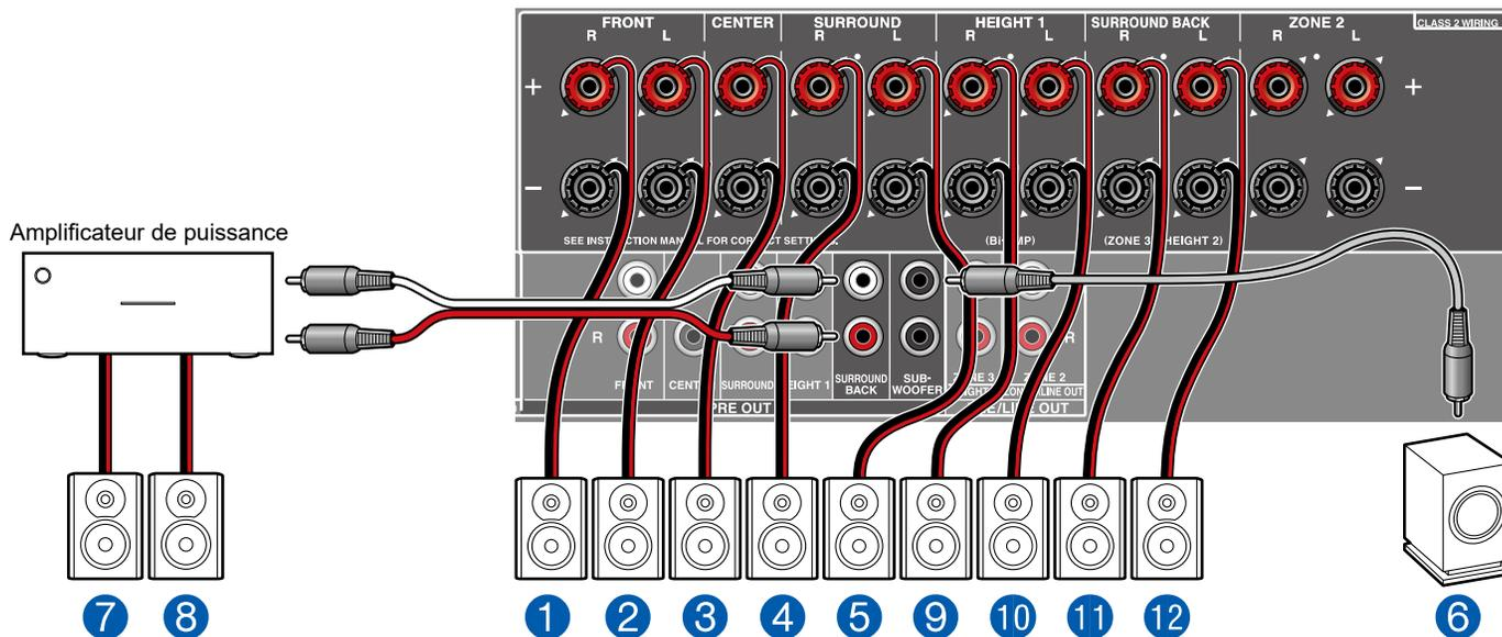
Il s'agit d'un exemple de combinaison d'enceintes pour plafond centrales à l'avant et d'enceintes en hauteur arrière à l'arrière sur le système 7.1. Il est possible de sélectionner les enceintes en hauteur à l'avant parmi les 4 types suivants. Les enceintes en hauteur pouvant être combinées à l'arrière diffèrent selon les enceintes en hauteur utilisées à l'avant.
