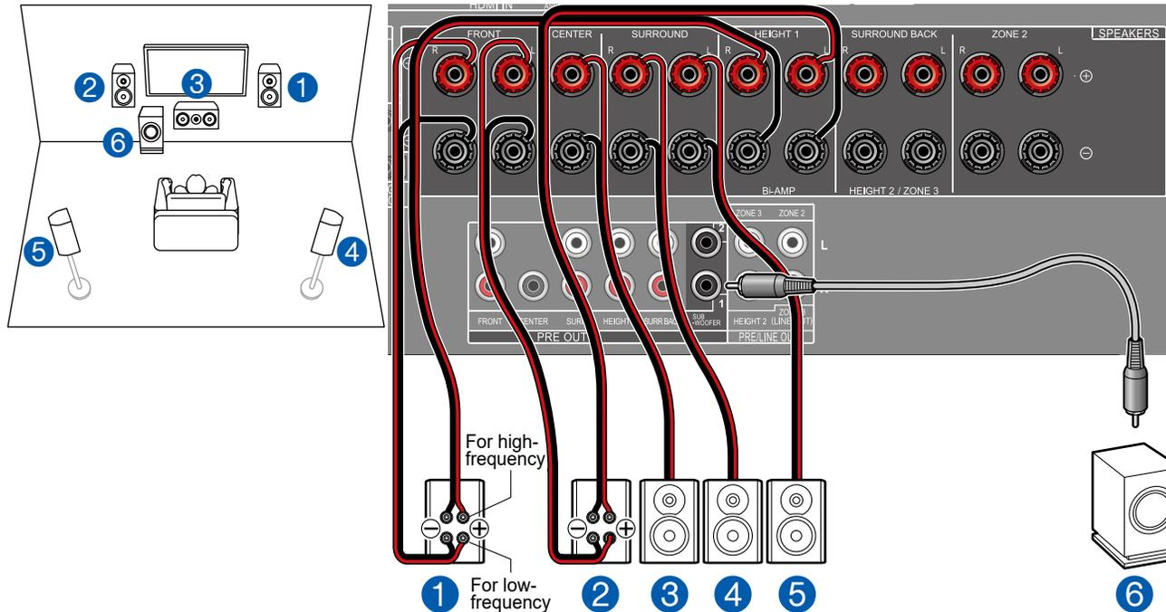
Vous pouvez configurer un système 5.1 (→p20) en raccordant des enceintes avant qui prennent en charge le raccordement de bi-amplification. Le raccordement de bi-amplification peut améliorer la qualité des plages graves et aiguës. Assurez-vous de retirer le cavalier raccordant les prises des graves et les prises des aigus des enceintes qui prennent en charge la bi-amplification. Consultez également le mode d'emploi de vos enceintes.
