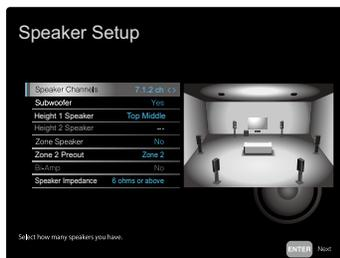
2. La combinaison d'enceintes sélectionnées à l'étape s'affiche 1. "Yes" s'affiche pour les enceintes sélectionnées. Si le réglage est correct, appuyez sur ENTER.
