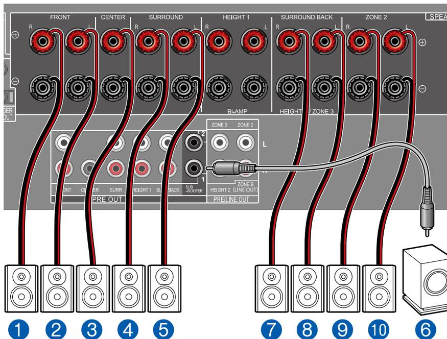
**MAIN ROOM :** Il s'agit d'un système 7.1 constitué du système 5.1 de base auquel ont été rajoutées des enceintes surround arrière. Pour plus de détails sur la disposition d'enceinte, consultez "Installation d'enceintes" (→p21).
