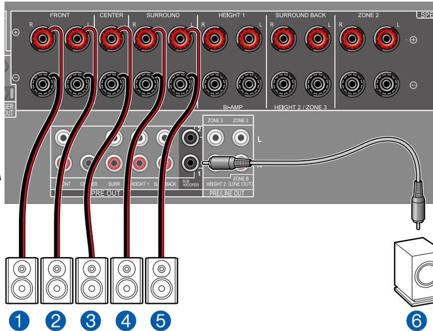
Il s'agit d'un système 5.1 de base. Pour plus de détails sur la disposition d'enceinte, consultez "Installation d'enceintes" (→p20).
