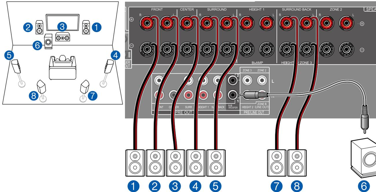
Il s'agit d'un système 7.1 constitué du système 5.1 de base auquel ont été rajoutées des enceintes surround arrière. Pour plus de détails sur la disposition d'enceinte, consultez "Installation d'enceintes" (→p21).
