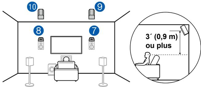
La distance entre les enceintes en hauteur arrière doit correspondre à celle des enceintes avant, et elles doivent être installées avec une élévation d'au moins 3' / 0,9 m de plus que les enceintes avant, et avec une inclinaison de sorte qu'elles pointent vers la personne qui écoute.
