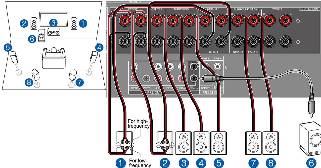
Vous pouvez configurer un système 7.1 (→p21) en raccordant des enceintes avant qui prennent en charge le raccordement de bi-amplification. Le raccordement de bi-amplification peut améliorer la qualité des plages graves et aiguës. Assurez-vous de retirer le cavalier raccordant les prises des graves et les prises des aigus des enceintes qui prennent en charge la bi-amplification. Consultez également le mode d'emploi de vos enceintes.
