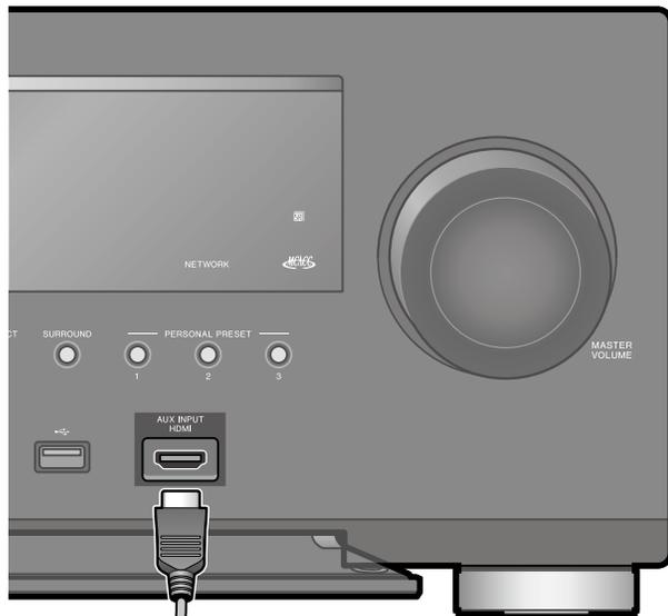
Raccordez une caméra vidéo, etc. à la prise AUX INPUT HDMI sur le panneau frontal à l'aide d'un câble HDMI.
