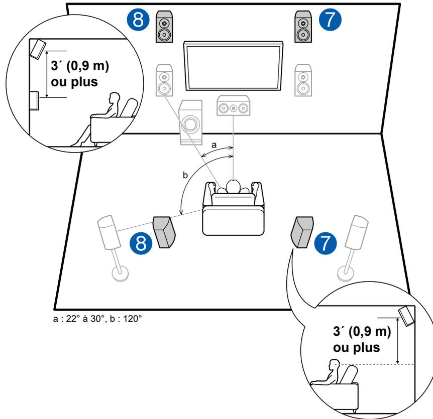
Il s'agit d'un système 5.1 de base ( →p20) constitué d'enceintes avant, d'une enceinte centrale, d'enceintes surround et d'un caisson de basse sous tension avec en plus des enceintes en hauteur avant ou des enceintes en hauteur arrière combinées. L'installation d'Enceintes en hauteur permet d'enrichir la sensation du champ sonore dans l'espace supérieur. Les enceintes en hauteur avant ou les enceintes en hauteur arrière devront être installées à au moins 3'0,9m au-dessus des enceintes avant.
