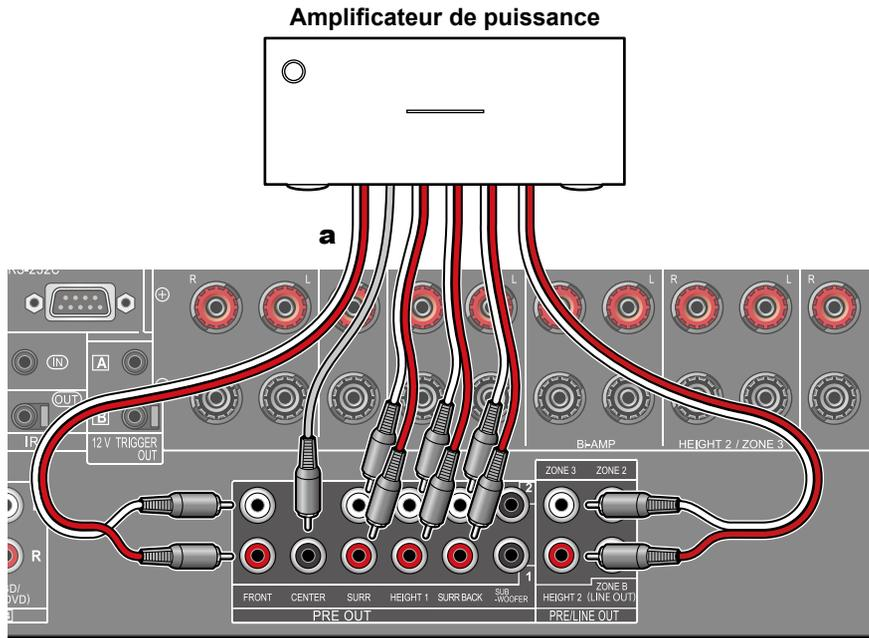
Vous pouvez raccorder un amplificateur de puissance à l'unité et utiliser l'unité comme préamplificateur afin de produire un volume élevé que l'unité seule ne peut pas générer. Raccordez les enceintes à l'amplificateur de puissance. Pour plus de détails, consultez le mode d'emploi de l'amplificateur de puissance.
