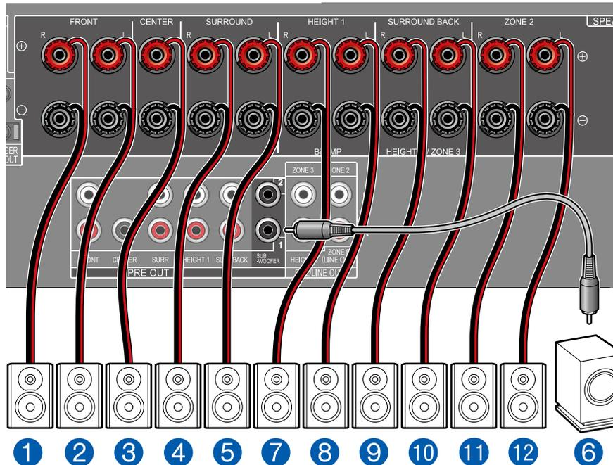
**MAIN ROOM :** Il s'agit d'un exemple de combinaison d'enceintes pour plafond centrales à l'avant et d'enceintes en hauteur arrière à l'arrière sur le système 5.1. Il est possible de sélectionner les enceintes en hauteur à l'avant parmi les 4 types suivants. Les enceintes en hauteur pouvant être combinées à l'arrière diffèrent selon les enceintes en hauteur utilisées à l'avant.
