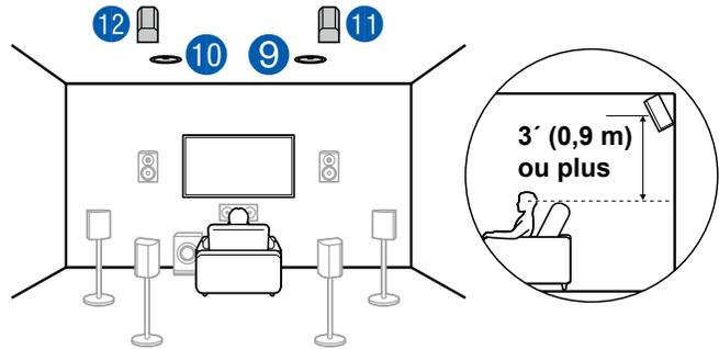
La distance entre les enceintes en hauteur arrière doit correspondre à celle des enceintes avant, et elles doivent être installées avec une élévation d'au moins 3' / 0,9 m de plus que les enceintes avant, et avec une inclinaison de sorte qu'elles pointent vers la personne qui écoute.
